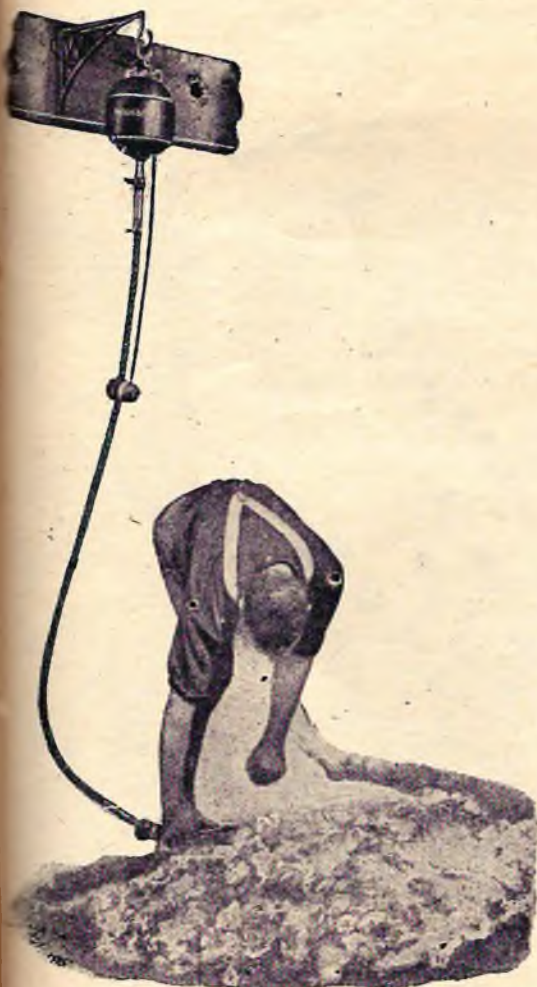
Рис. 5. Стригальная машинка с электрическим мотором
